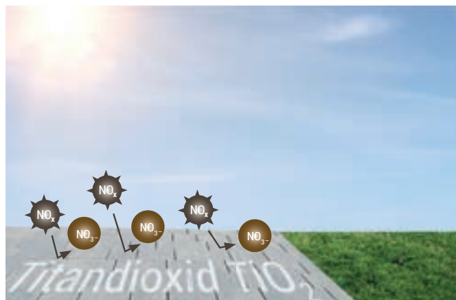
A titándioxid ( \text{TiO}_2 ) a napfény segítségével nitráttá ( \text{NO}_3^- ) alakítja át a nitrogénoxidokat ( \text{NO}_x ).
